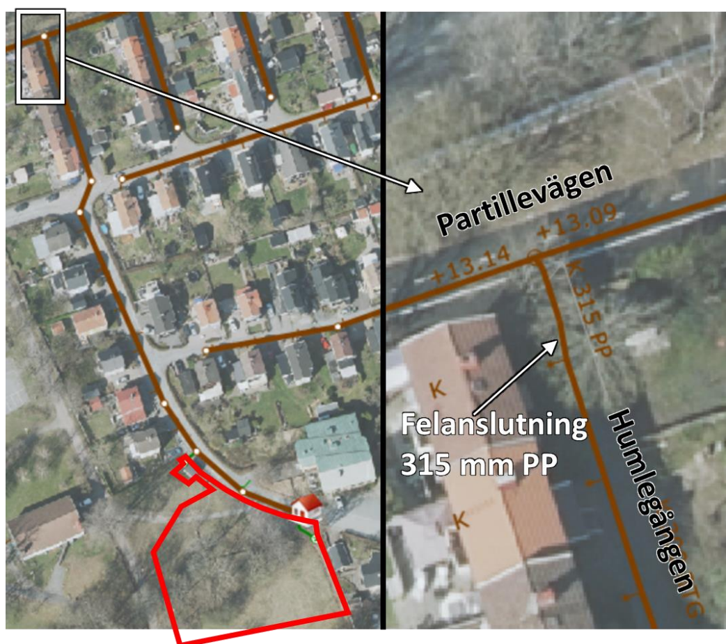
Figur 15. Översikt ledningssystem nedströms planområdet, markerat i rött, samt inzoomning på ledningssträcka där 315 PP har blivit felansluten till befintlig 300 BTG.
